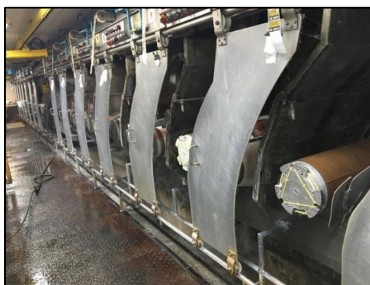
Figura 16 – Foto das enroladeiras, canal 4 com proteções parciais de máquinas
